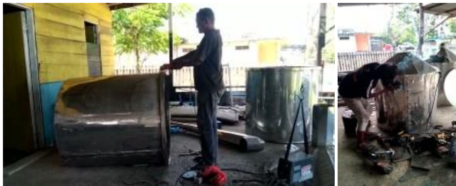
Gambar 3. Proses Pembuatan Badan Ketel
