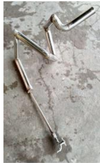
Gambar 4.4. Pipa Sirkulasi Gambar 4.5. Pipa Sirkulasi Uap, Uap, Diluar Ketel Pendingin Didalam Ketel Pendingin Gambar 4. Bagian-Bagian Alat Penyulingan Minyak Kayu Putih
