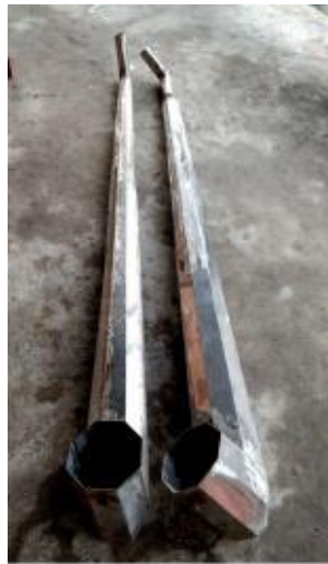
Gambar 4.4. Pipa Sirkulasi Gambar 4.5. Pipa Sirkulasi Uap, Uap, Diluar Ketel Pendingin Didalam Ketel Pendingin Gambar 4. Bagian-Bagian Alat Penyulingan Minyak Kayu Putih
